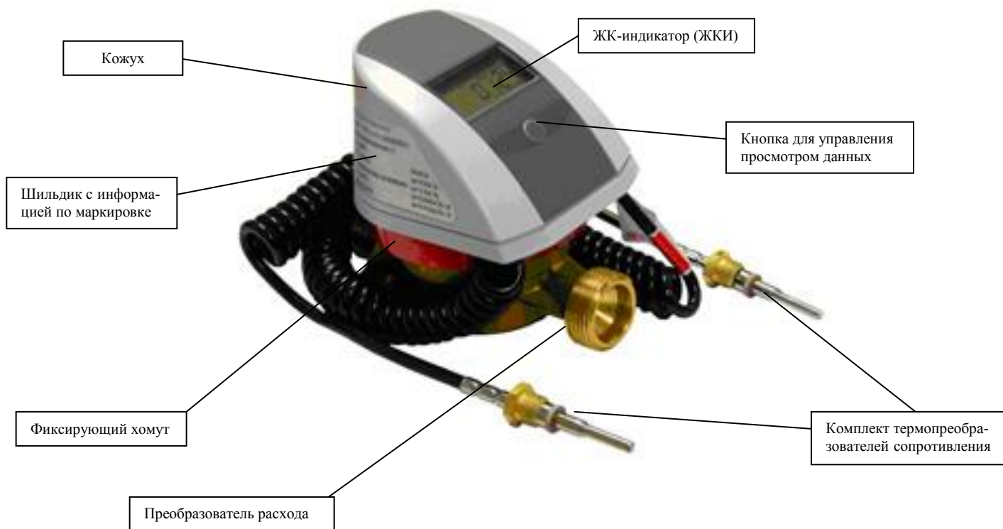
Рисунок 2. Внешний вид и состав теплосчётчика ELF-M
