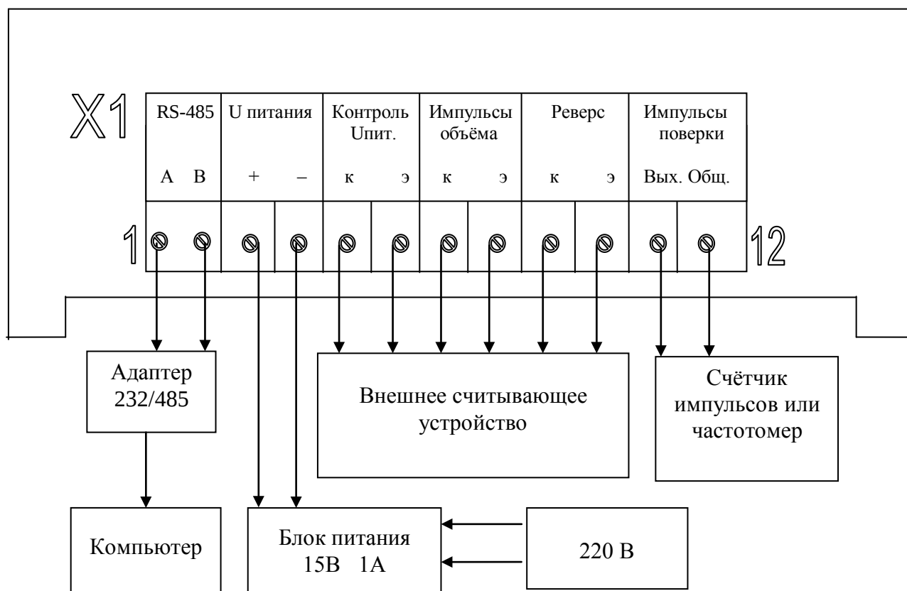
Рис.2. Схема подключения блока питания и внешних устройств (вычислителя тепловой энергии ВТЭ-1 П и персонального компьютера ПК).
